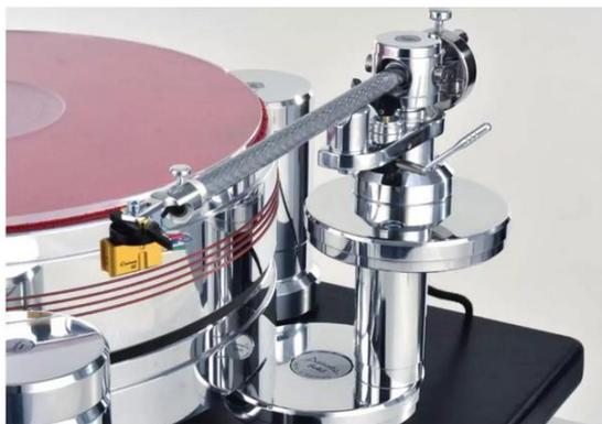
Das Eminent GL von My Sonic Lab wiegt knapp zehn Gramm. Seine für heutige Verhältnisse eher geringe Nadelnachgiebigkeit macht auch die Verwendung schwererer Tonarme möglich. Der Tonabnehmer kombiniert sehr geringen Ausgangswiderstand mit einem hohen Ausgangspegel, ermöglicht durch sehr starke Magnete und einem speziellen Material für die Spulenkern.
